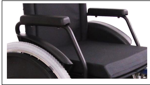
Figura 4: Detalhe do encosto de fibras de poliéster
