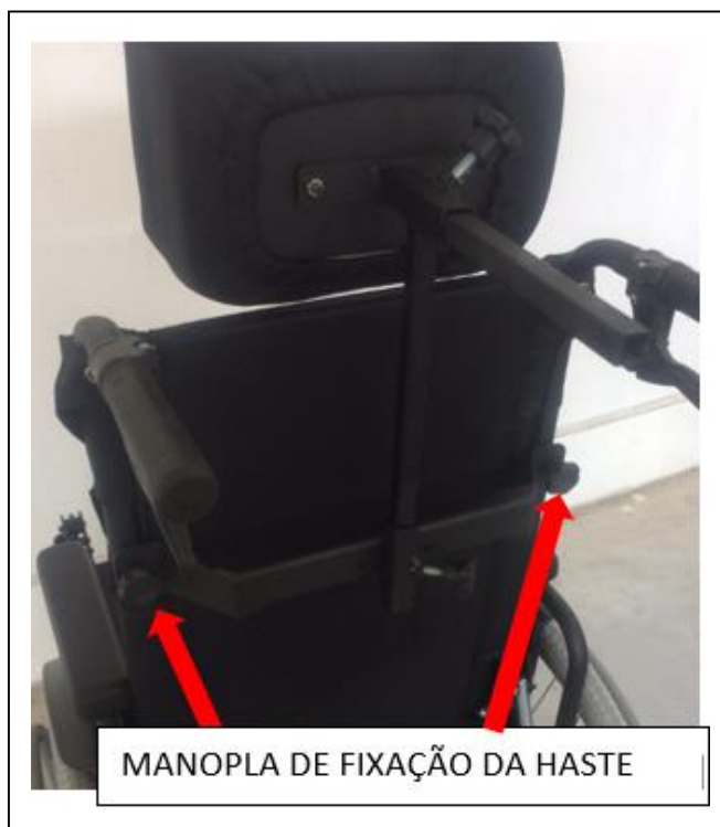
Figura 7: Imagem da remoção das manoplas de fixação da haste de suporte do apoio de cabeças
