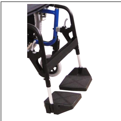
Figura 2: Detalhe do apoio de pés
