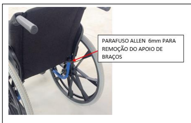
Figura 14: Remoção completa do apoio de braços
