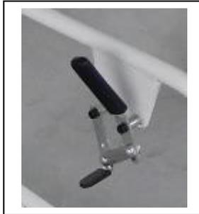
Figura 7: Detalhe do freio manual
