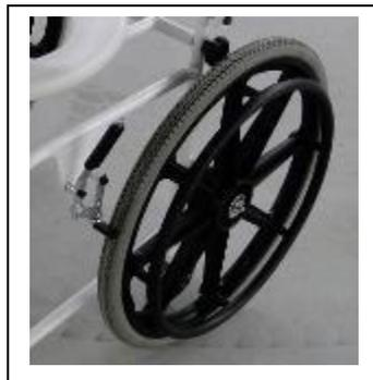
Figura 8: Detalhe da roda traseira com diâmetro de 20" e eixo quick
